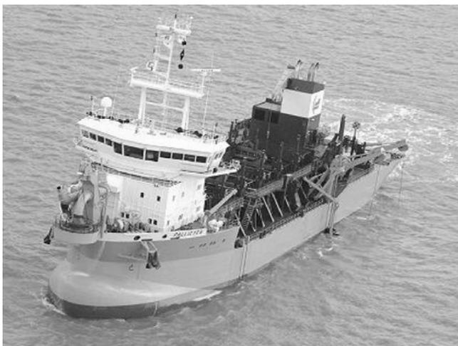
**Рис. 4. Самоотвозной землесосный снаряд**
