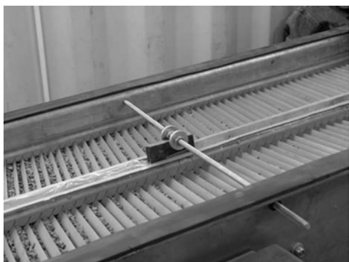
Рис. 5. Упругоэластичное крепление концентрационного элемента в его центральной части
