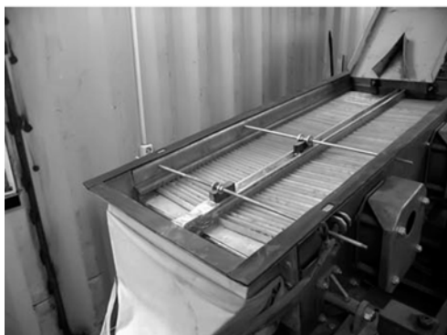
Рис. 4. Общий вид виброконцентратора, установленного на грохоте ULS 1,5 x 0,6
