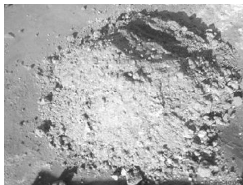
Рис. 2. Пробы до и после измельчения с влажностью 30 % в замершем состоянии
