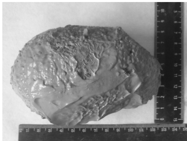
Рис. 2. Окатыш на стадии уплотнения
