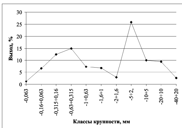
Рис. 2. Гранулометрическая характеристика продуктов дробления ДКД-300
