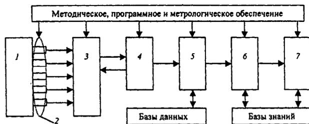
**Рис. 1. Общая структурная схема разработанной геоинформационной системы:** 1 - объект исследования; 2 - датчики; 3 - согласующее устройство; 4 - устройство сбора информации; 5 - подсистема предварительной обработки информации; 6 - подсистема оценки свойств, структур, строения и состояния контролируемого объекта; 7 - подсистема принятия решения на основе экспертных оценок
