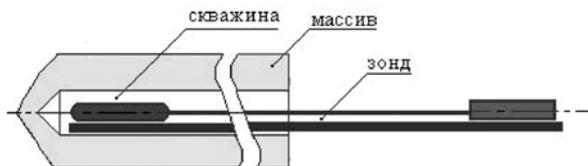
**Рис.4. Схема измерений с помощью скважинного зонда ЗЭМИ-1**
