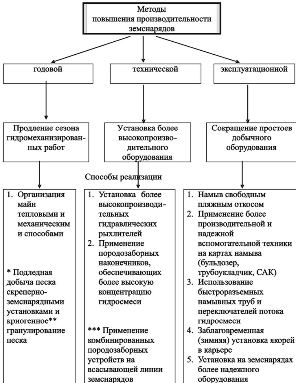
**Рис. 3. Методы повышения производительности земснарядов и способы их реализации**
