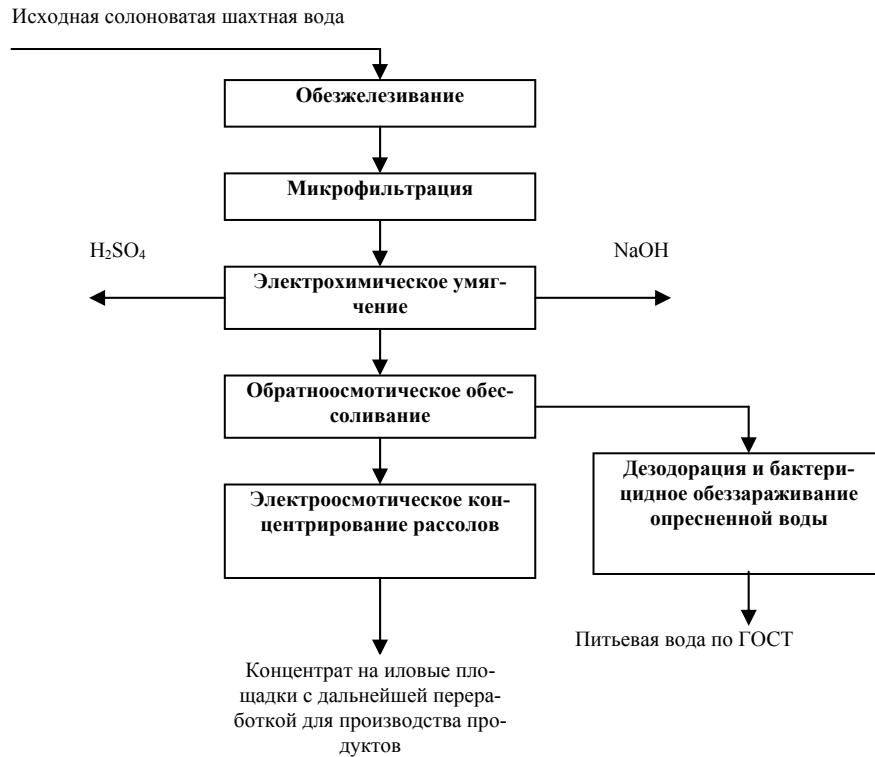
**Рис. 2. Принципиальная схема процесса комплексной очистки шахтных вод**
