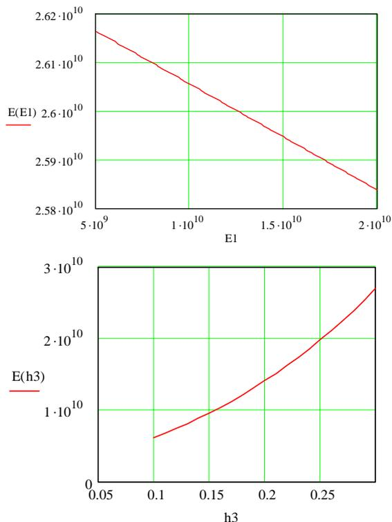
**Рис. 4. Зависимость эквивалентного модуля упругости для трехслойной пластины от модуля упругости нижнего слоя**
