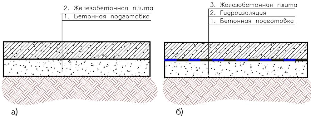
**Рис. 1. Схематическое изображение типовых многослойных строительных конструкций:** а) двухслойные; б) трехслойные
