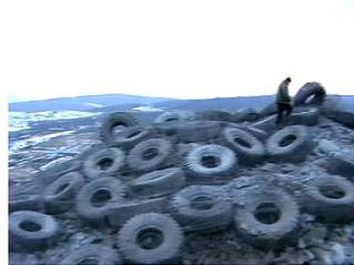
**Рис. 2. Положение элементов укрытия после взрыва**
