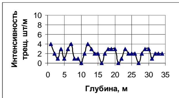
**Рис. 6. Интенсивность трещиноватости (шт/м) по данным телесъемки вдоль ствола разгрузочной скважины на гор +595 м карьера Центрального рудника**
