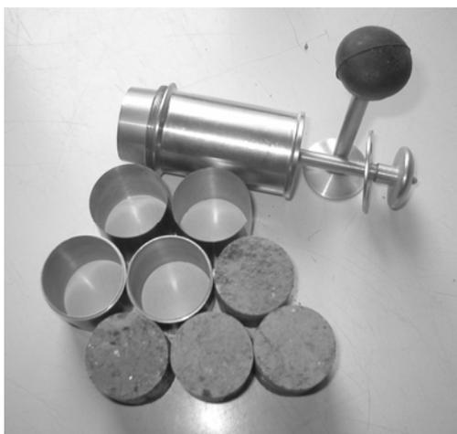
**Рис. 1. Пробоотборник с образцами**
