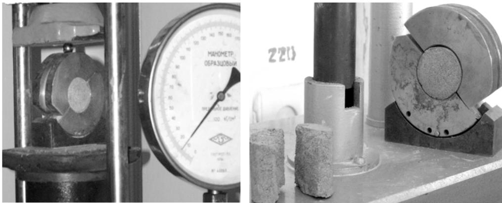
**Рис. 4. Испытание образцов на срез**
