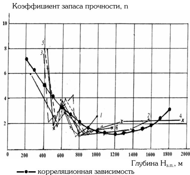
**Зависимость коэффициента запаса прочности горных пород от глубины их залегания по данным проб геологоразведочных скважин:**
