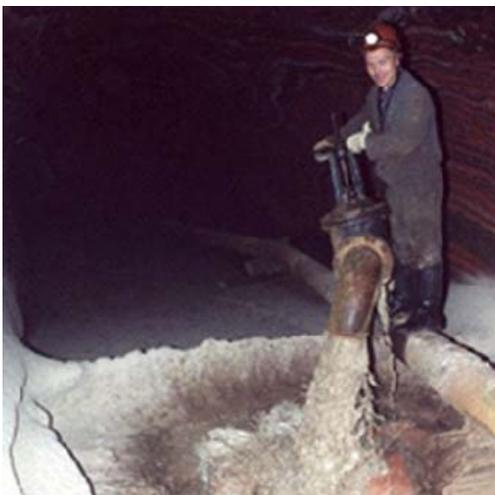
**Рис. 2. Гидравлическая закладка.**
