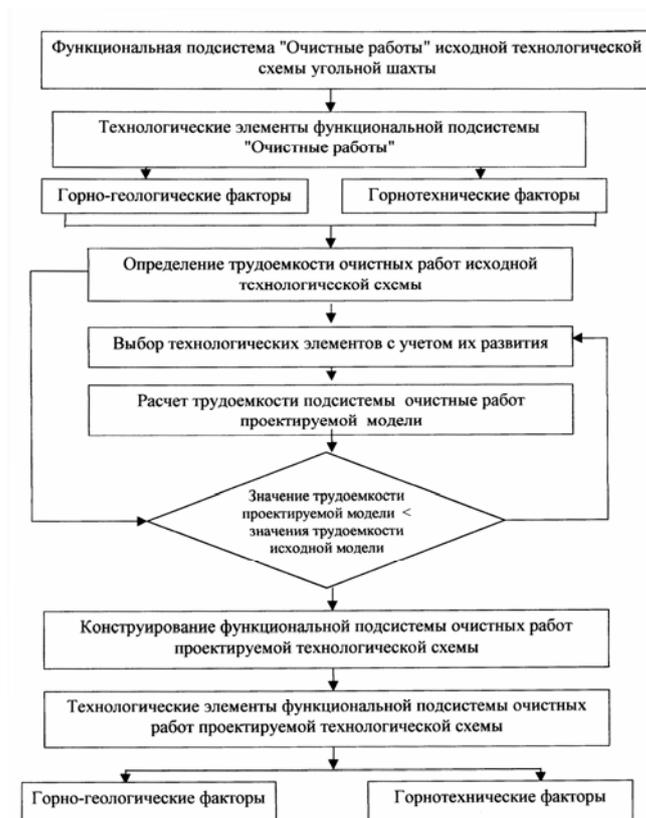
Рис. 4. Методика оптимизации функциональных подсистем технологических схем угольной шахты
