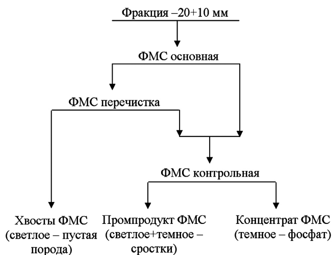
Рис. 1. Схема фотометрической сепарации класса -20+10 мм исходной руды пробы 2 месторождения Коксу
