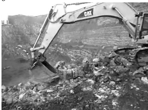
Рис. 2. Безвзрывная технология переработки скальной вскрыши с применением гидромолота (а) и ковша (б) экскаватора CAT 330 DL
