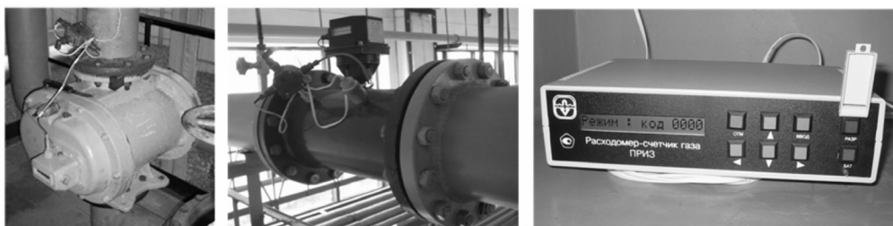
Рис. 2. Измерительный комплекс ПРИЗ, предназначенный для промышленного учета природного газа-метана
