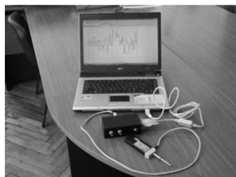
**Рис. 5. Внешний вид прибора с подключенным датчиком перемещения**
