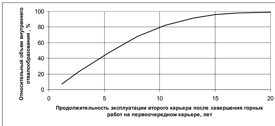
**Рис. 2. Изменение относительного объема внутреннего отвалообразования (по отношению к объему вскрыши в проектных границах второго карьера) в зависимости от продолжительности эксплуатации второго карьера после завершения горных работ на первоочередном карьере**
