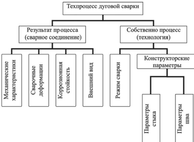
**Рис. 1. Общепринятая классификация показателей, характеризующих дуговую сварку**
