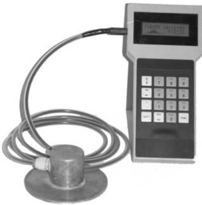
**Рис. 1. Внешний вид цифровой аппаратуры виброакустического контроля «Vibroset»**
