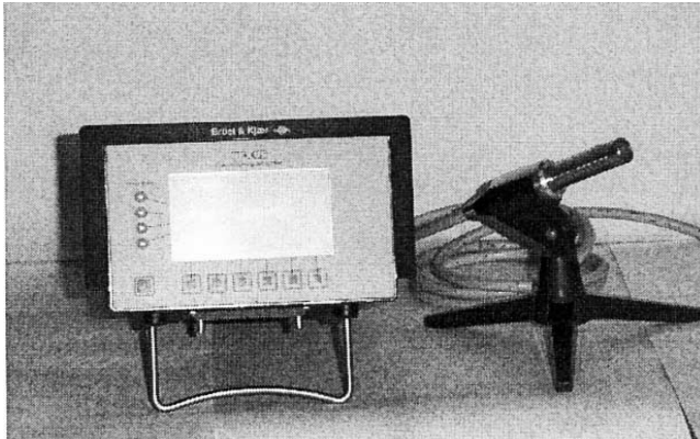
Рис. 1. Датчик акустических колебаний на базе микрофона 4147 с Preamplifiers Delta Tron 2693 A-OS2
