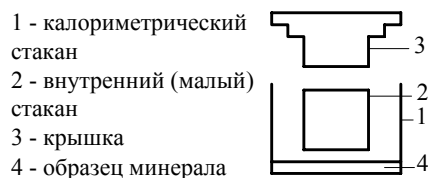
Рис. 1. Калориметрический стакан для измерения теплот взаимодействия флотореагентов с минералами
