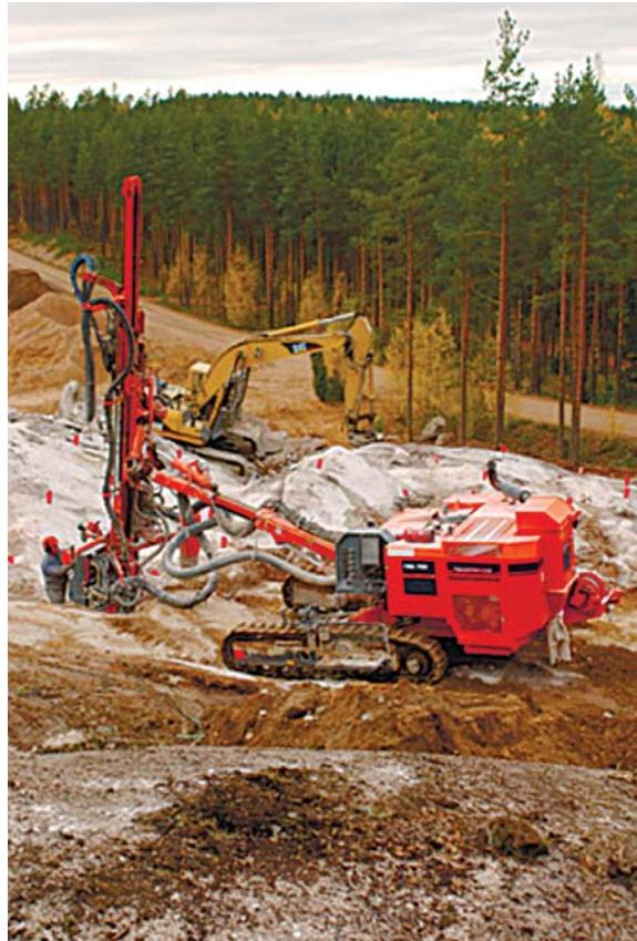
Гидроприводной блок модели Sandvik DQ440, предназначенный для продольной разделки и выравнивания боков каменных блоков, монтируется на экскаваторе для работы на открытых каменных карьерах. Для повышения производительности он оснащается 4 колонковыми перфораторами марки HEX1, которые могут использоваться со стальными буровыми штангами размером Н19 или Н22 мм (3/4" или 7/8").
