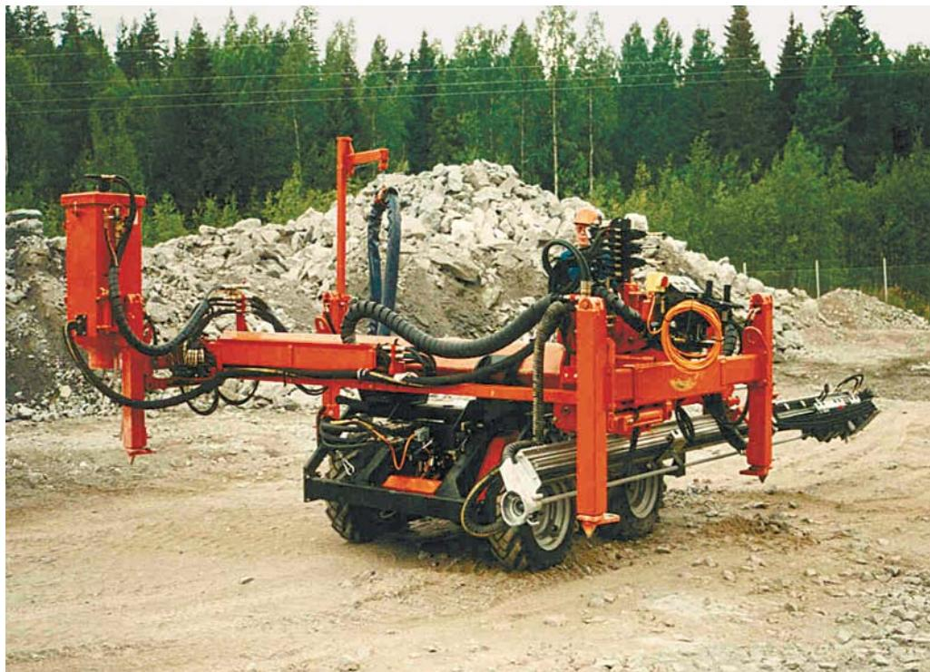
Гидравлический буровой станок модели Sandvik DQ100 предназначен для первичного и вторичного бурения по линии при работе на открытых каменных карьерах.
